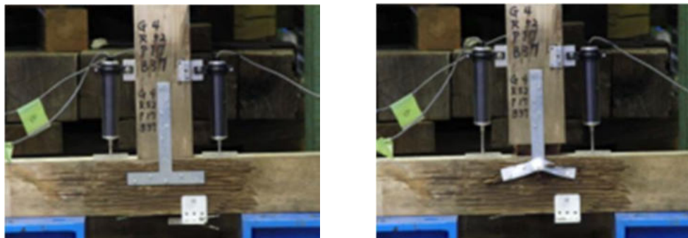
b : 接合部の状況（左：試験前、右：試験後）
