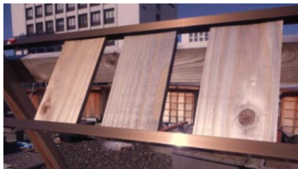
b : 試験片設置のようす
