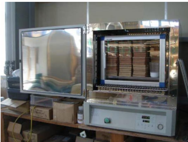
c : 保存処理木材との接触安全性検証実験 高湿実験
